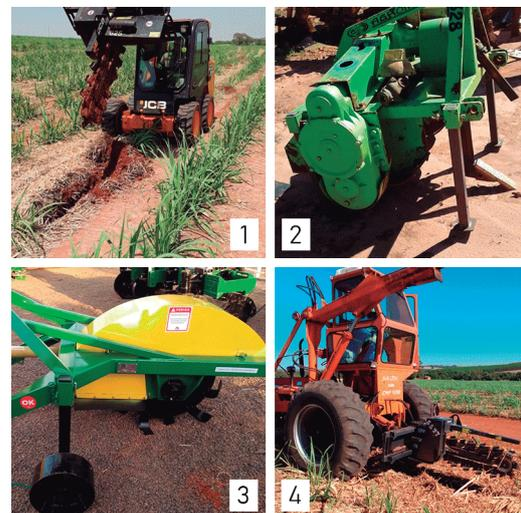
Figura 13 - Modelos de canterizadores: 1. BOBCAT / 2. Canterizador A / 3. Canterizador B / 4. Valetadeira acoplada em carregadora de cana.
